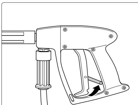
**Sicherungssperre an der Pistole nach jedem Gebrauch umlegen, um unbeabsichtigtes Strahlen unmöglich zu machen!**
