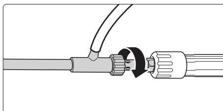
1. Hochdruckreiniger wie bei normaler Reinigung anschließen. Sandstrahlinjektor mit der Pistole verbinden. **Unbedingt darauf achten, daß der Anschluß des Saugschlauches nach oben gerichtet ist, damit kein Wasser eindringen kann und zusammen mit dem angesaugten Sand den Schlauch verstopft.**
