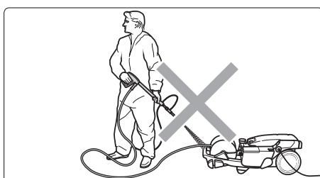
... diriger le jet d'eau ou de sable sur le nettoyeur haute pression;
