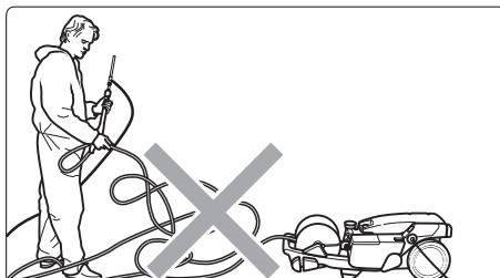
... tendre le flexible haute pression s'il y a formation de boucles, le tirer ou le laisser frotter sur une arête vive;
