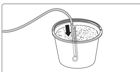
2. Sauglanze in den Behälter mit dem Sandstrahlmittel stecken. **3. Pistole betätigen.** Durch den Wasserstrahl im Injektor wird ein Unterdruck erzeugt, der den Sand in das Strahlrohr saugt, wo sich Wasser und Sand vermischen.
