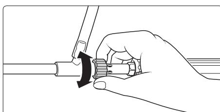
4. Die Sandmenge kann an der schwarzen Mutter reguliert werden. **Das Strahlmittel muss absolut trocken sein.**
