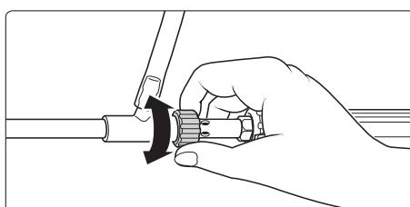
**1.** Raccorder le nettoyeur HP comme pour une utilisation normale. Relier l'injecteur de sable au pistolet. **S'assurer que l'orifice de raccordement du tuyau d'aspiration de sable soit présenté vers le haut de manière à ce que de l'eau ne puisse y entrer, ce qui provoquerait son obturation en liaison avec le sable.**
