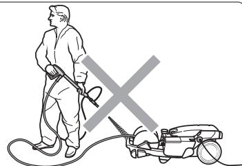
**Wasser- bzw. Sandstrahl nicht auf den Hochdruckreiniger richten!**
